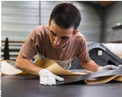
Le drapage des plis en pré-imprégnés carbone nécessite beaucoup de minutie et de rigueur. « Nos compagnons ont de l'or au bout des doigts. C'est un savoir-faire manuel qui relève de l'artisanat d'art », s'enthousiasme Jean-Paul Dufau.
